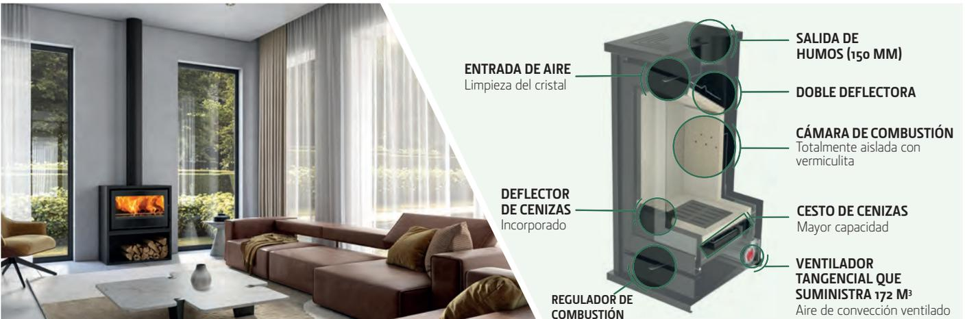
Todas las estufas de leña para calefacción local tienen un deflector para dirigir las cenizas hacia el cajón, con el fin de facilitar la limpieza de su equipo. Poseen un deflector doble: uno en chapa y otro en vermiculita, haciendo el equipo más eficiente. La circulación de aire en su interior, contribuye a que el cristal esté siempre limpio durante su funcionamiento.
