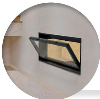
La llave utilizada para abrir y cerrar la puerta vertical también sirve para inclinar la puerta hacia delante en un ángulo de 45°, para facilitar la limpieza del interior del cristal. El cristal es del tipo vitrocerámico termorresistente, que soporta temperaturas de hasta 750°C en uso continuo. Ambos modelos pueden equiparse con un marco de 4 lados de 4,4 cm o 7,4 cm.
